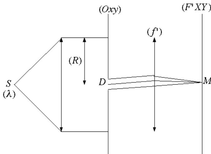
On rappelle que l'amplitude complexe, en un point  $M(X, Y)$  du plan focal de la seconde lentille de distance focale  $f'$ , de la figure de diffraction obtenue par un diaphragme  $\mathcal{D}$  du plan  $xOy$  éclairé par une source monochromatique (de longueur d'onde  $\lambda$ ) à l'infini dans la direction de  $Oz$  est donnée par la formule suivante qui traduit le principe de Huygens-Fresnel :
